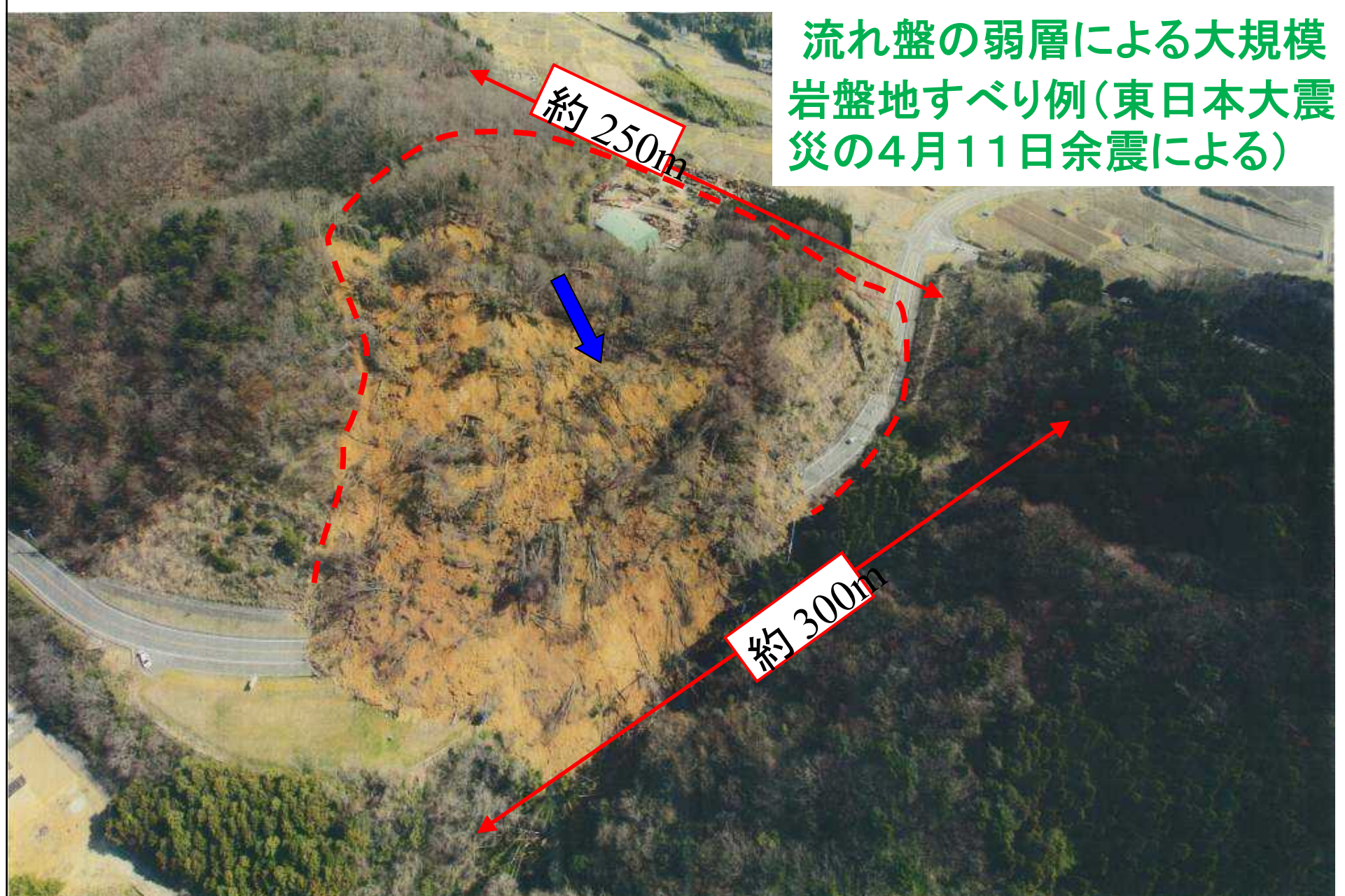
上釜戸地すべりによる県道の被災
