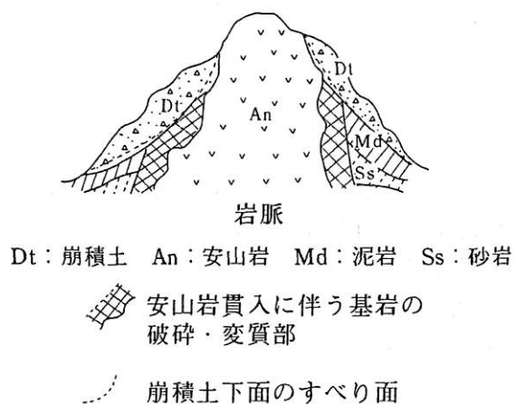
図-5.3.15 安山岩貫入に起因する 崩積土地すべりのモデル
