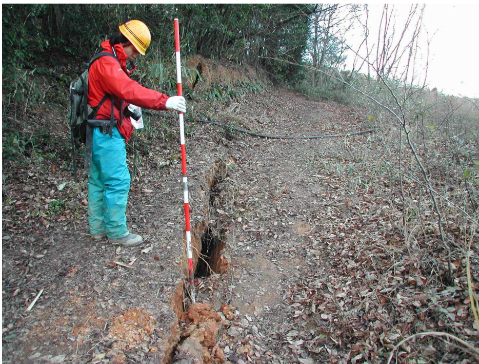
段差を伴う開口クラック、植生分布域での見逃しに注意
