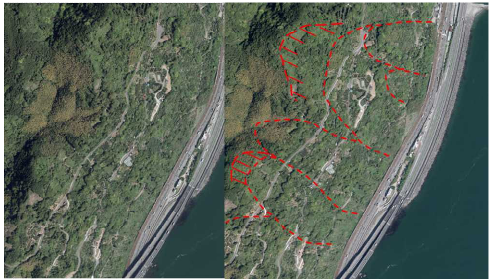
図-3.7 (1) 由比地区地すべりの空中写真判読図
