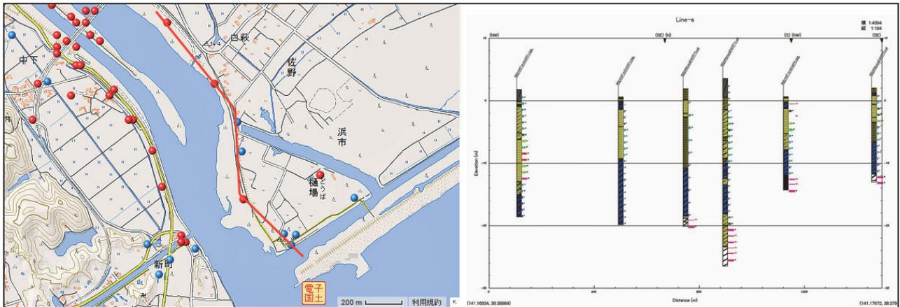
2つの事業者のボーリングデータ(XML)を利用して地質断面図を作成する過程(イメージ)
