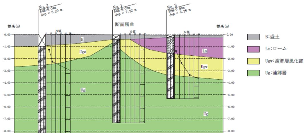
図-5 地質断面図の例
