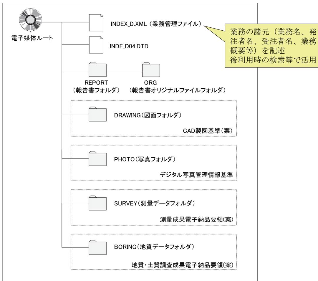
図-2 土木設計業務の電子成果品のフォルダ構成
