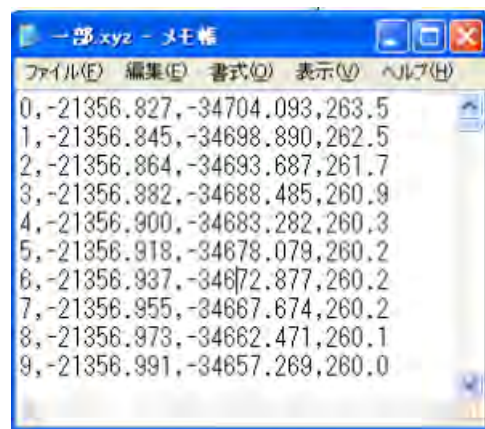
図 2-5 基盤地図情報ビューア 基盤地図情報ビューアから出力したデータ形式。ID,X,Y,Z の並びで出力される。
