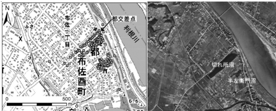
図5 東北地方太平洋沖地震に伴う我孫子市布佐地区の液状化の発生状況（宇根ほか，2015）と被災地域がかつて沼であったことを示す1947年米軍撮影空中写真（国土地理院）。土地の成り立ちを反映して液状化が発生したことは明らかだが，地震前に配布されていた液状化危険度マップでは液状化のおそれはないとされていた。
