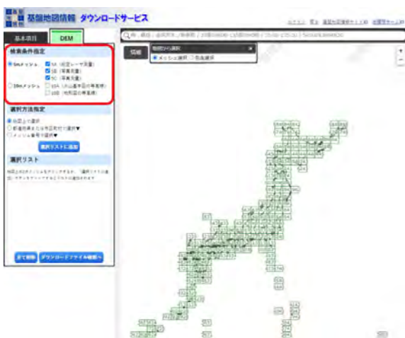
図 2-3 基盤地図情報ダウンロードサービス画面 航空レーザ測量成果より作成された 5m メッシュをダウンロードするには、5A を選択する。 出典： https://fgd.gsi.go.jp/download/menu.php
