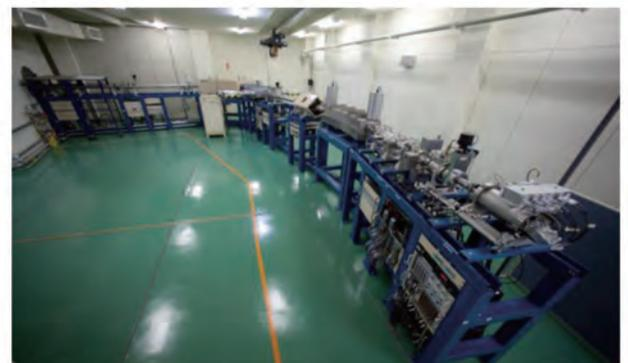
図-5 加速器質量分析装置 (5MV)
