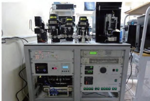
図-7 四重極型質量分析装置 (ASI 社製 Alphachron)
