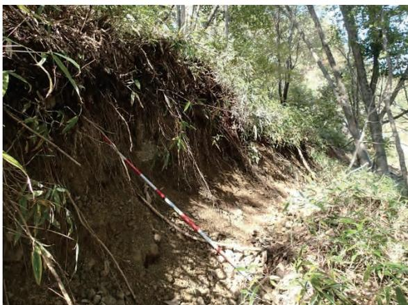
写真5 移動土塊中に見られる滑落崖
