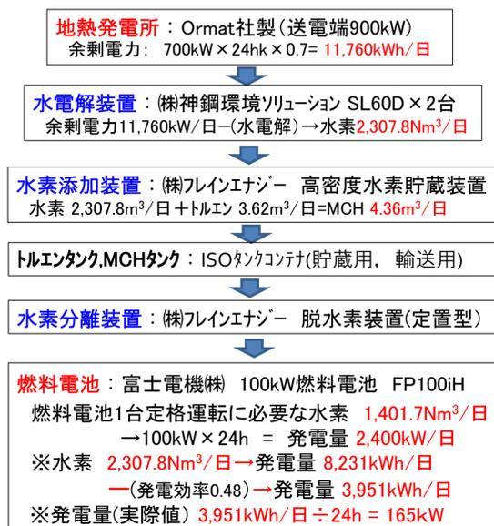
図-10 全体システムの構成設備の検討結果
