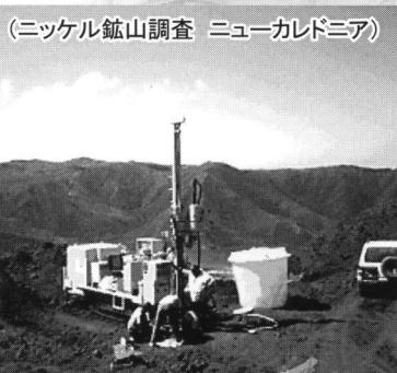
ワイヤーライン工法用削孔機
