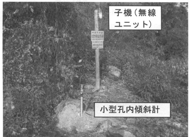
図9 小型孔内傾斜計の設置状況
