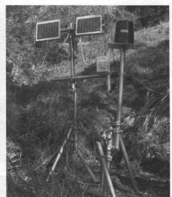
図1 斜面の無線モニタリング(左下:子機、右下:親機)
