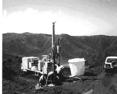
ワイヤーライン工法用削孔機
