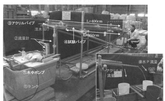
写真 1 アクリルパイプを用いた室内試験（孔壁自立を想定したケース）
