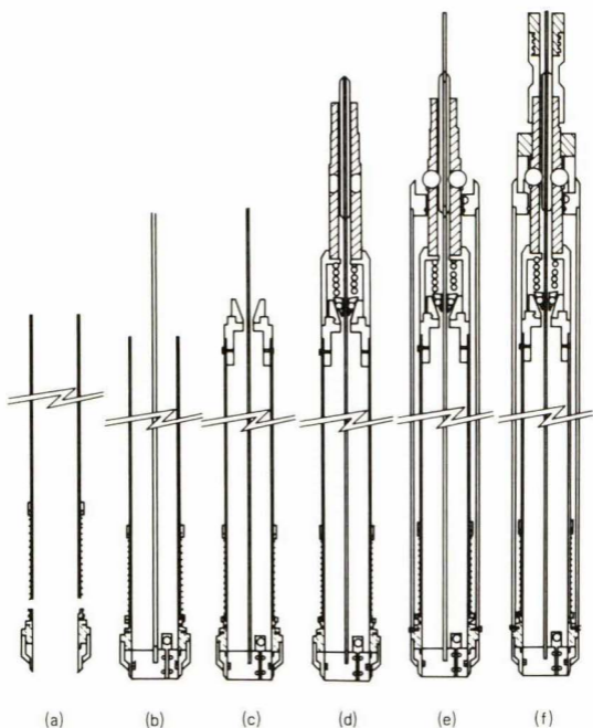
図3.21 ツイストサンプラーの組立て手順
