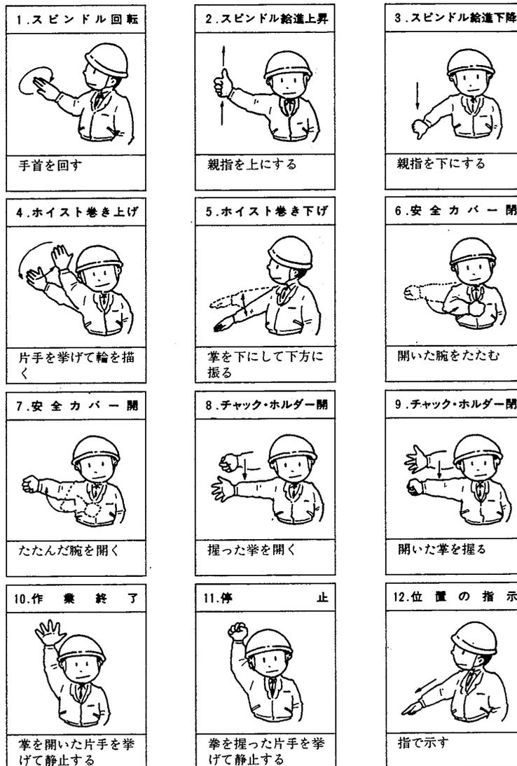
図 2.8.7 ボーリングマシンにおける合図の例
