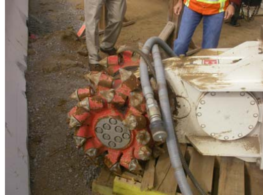
写真-40 掘削機の先端部
