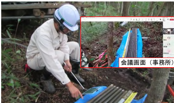
写真-1 ウェアラブルデバイスを用いた ボーリング現場でのオンライン検尺状況・会議画面
