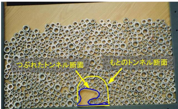
写真-7 ケース1 トンネル断面はつぶれる
