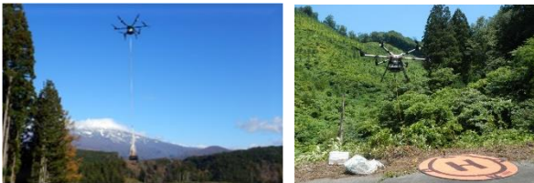
写真-4 ドローン運搬状況
