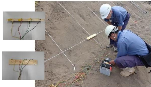
写真-2 簡易電気探査状況
