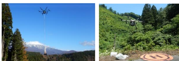
写真-4 ドローン運搬状況
