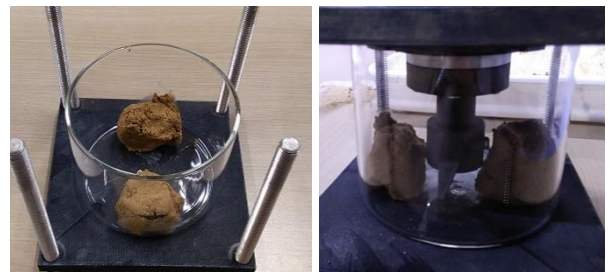
写真-3 粘性土サンプルの設置状態
