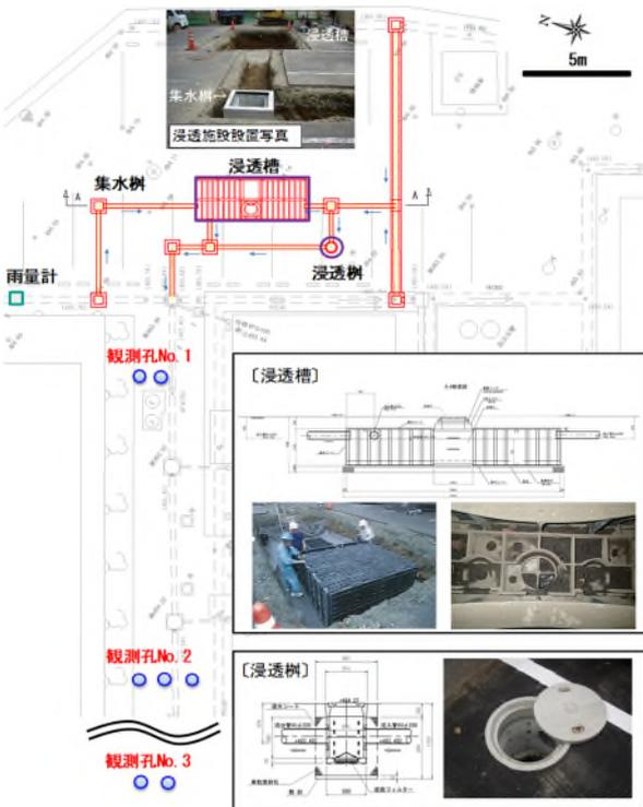
図-1 浸透施設及び観測孔の位置図
