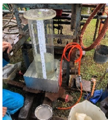
図-5 地下水面より上の地盤の透水試験例 4)
