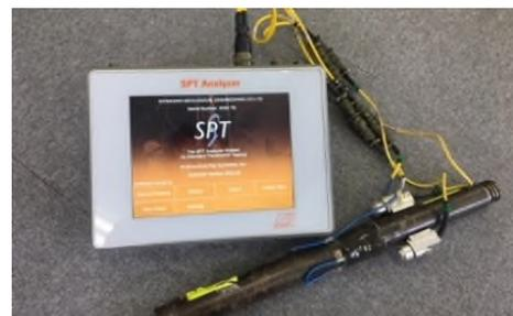
写真-1 SPT アナライザーと測定装置
