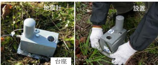
写真-1 地震計の台座、地震計の設置
