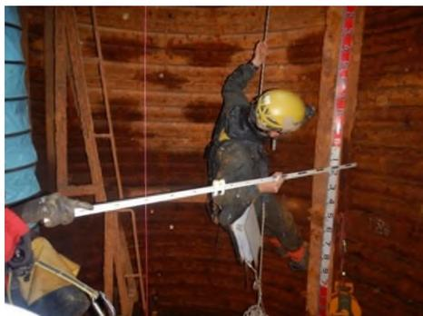
写真-4 下げ振り子による調査状況
