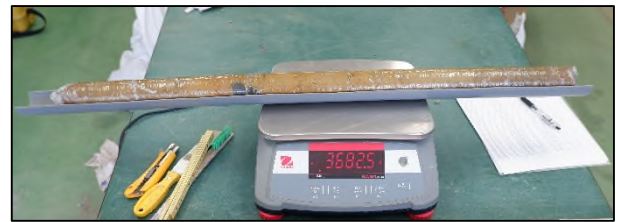
写真-1 コアの質量測定
