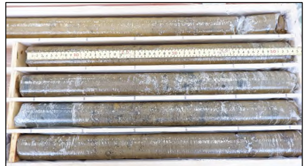
写真-2 コアの長さ測定
