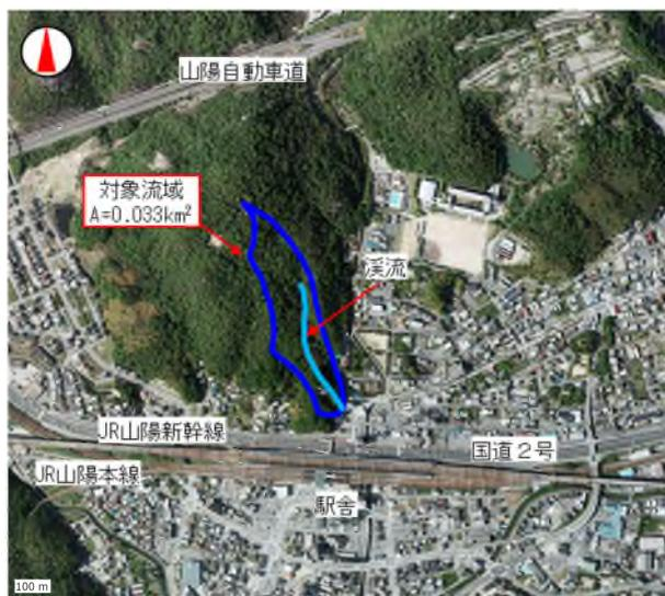
図-1 対象流域の空中写真(に加筆)<sup>1)</sup>
