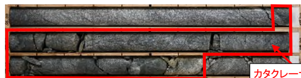
写真-2 断層間コア写真(下流側)
