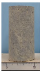
図-5 岩石コアと一軸圧縮試験結果
