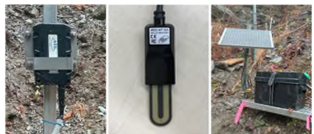
図-3 観測システムで使用する機器 (左から測定器本体・土壤水分センサー・電源)
