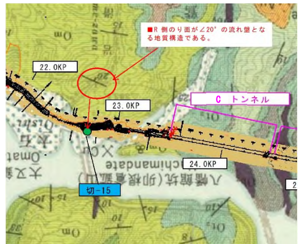
図8 流れ盤構造となる切土のり面(切-15地点)
