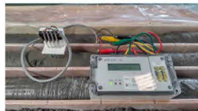
写真-3 比抵抗の測定状況
