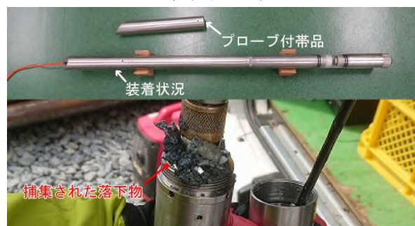
図-3 プローブ付帯品の装着状況と効果
