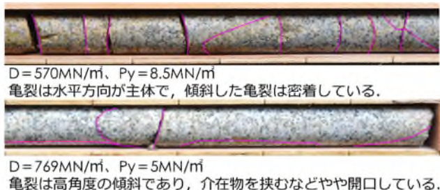
写真-1 亀裂の傾斜状況(コア写真)
