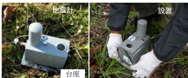
写真-1 地震計の台座、地震計の設置
