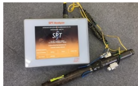
写真-1 SPT アナライザーと測定装置
