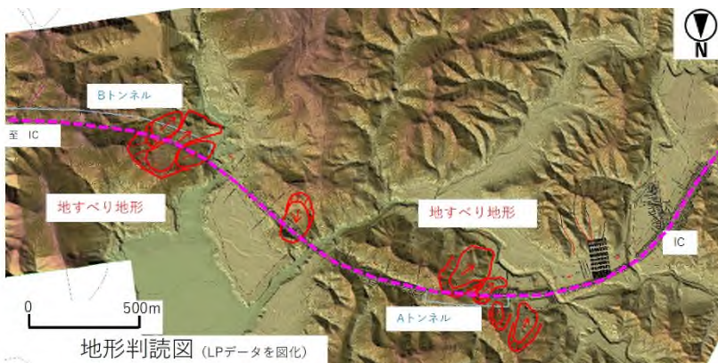
図5 Aトンネル・Bトンネルを横断する地すべり地形 (地形図はLPデータより作成)
