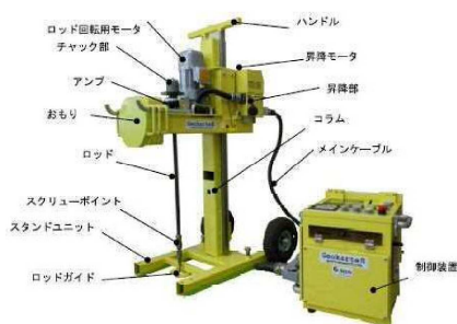
図-1 SDS試験装置全体図 1)
