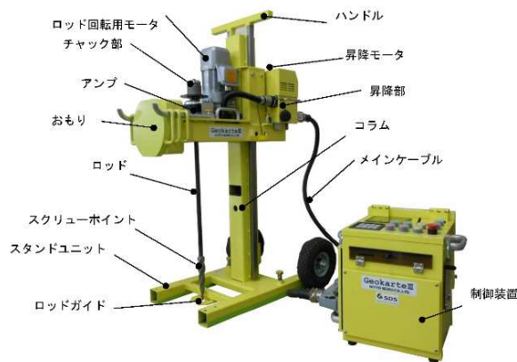
図-3 SDS 試験装置全体図 2)
