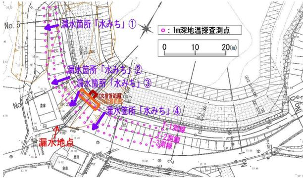
図-3 1m 深地温探查結果平面図
