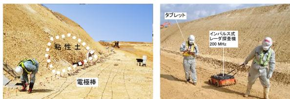
図-3 電気探査(左)と地中レーダ探査(右)
