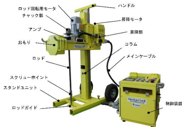
図-3 SDS 試験装置全体図 2)
