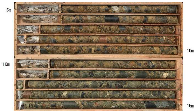
写真-3 軽量型ボーリングにより採取したコア
