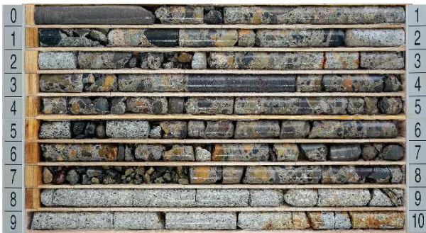
写真-2 採取コア状況(コアドリル)
