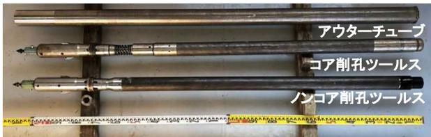
写真-1 メタルビット用削孔ツール
