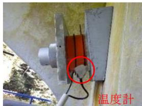
写真-3 後付け荷重計
