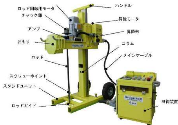
図-3 SDS 試験装置全体図 2)
