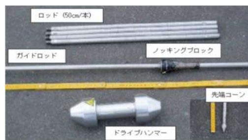
図-3 簡易動的コーン貫入試験器 1)
