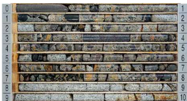
写真-2 採取コア状況(コアドリル)
