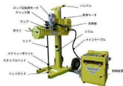
図-1 SDS試験装置全体図 1)
