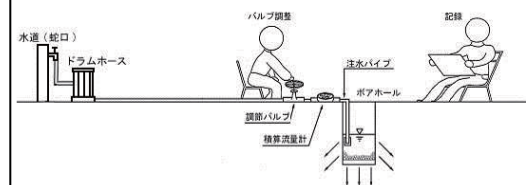
図-3 浸透試験状況概要 1)
