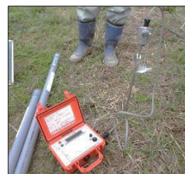
写真-1 1m 深地温探査機材
