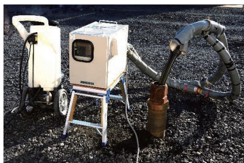
写真-1 TRT測定状況
