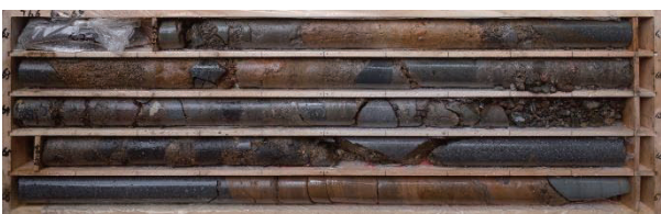
写真-2 凝灰質火山礫層
