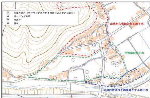
図-6 地下水流動系統区分図 (国土地理院地図<sup>1)</sup> に加筆)
