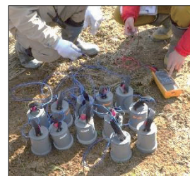
写真-2 自然電位探査電極
