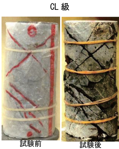
写真-2 多段階三軸圧縮試験前後の供試体(CL 級)
