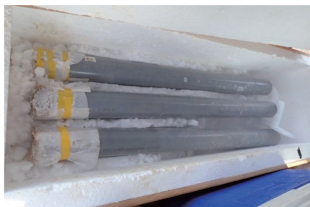
図-3 採取試料の凍結状況
