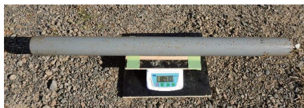
図-2 現場での試料の質量測定状況
