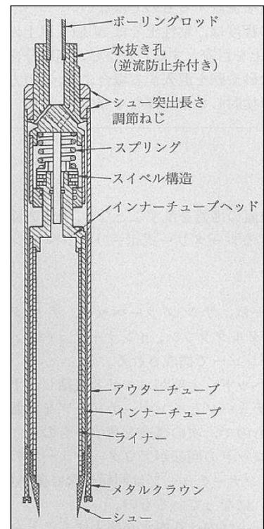
図-3 ロータリー式三重管サンプラー<sup>2)</sup>
