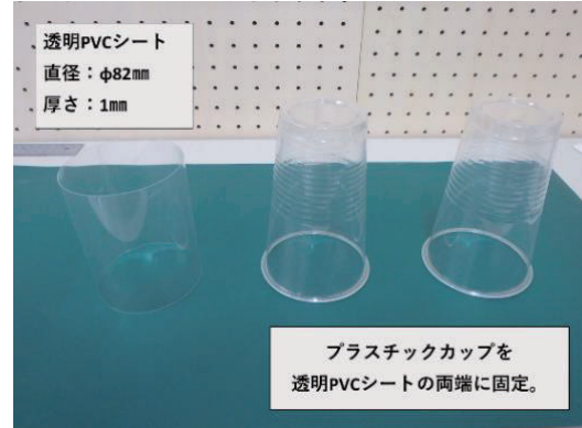
図-2 透明アタッチメントの部材
