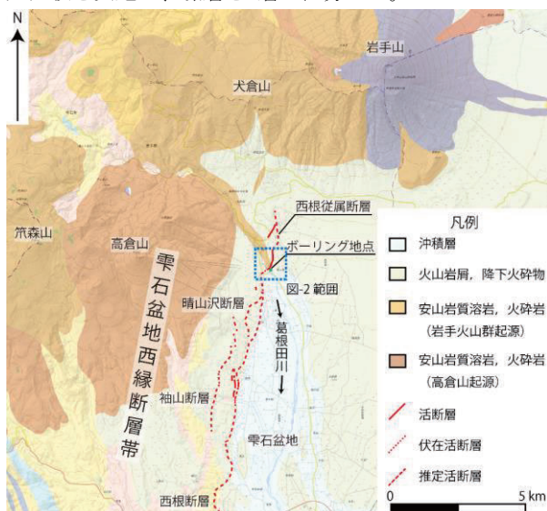
図-1 雫石盆地西縁断層帯北部の地質図 3) と調査位置 (基図は地理院地図、断層位置は1)による)
