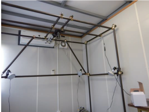
写真-1 ガーデンアグリパイプを使用したコア撮影装置
