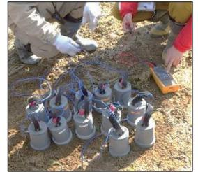
写真-2 自然電位探査電極
