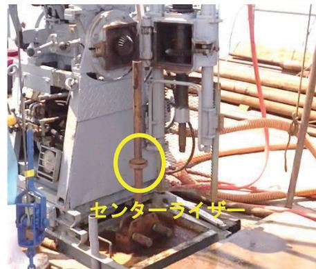
写真-1 センターライザー設置状況
