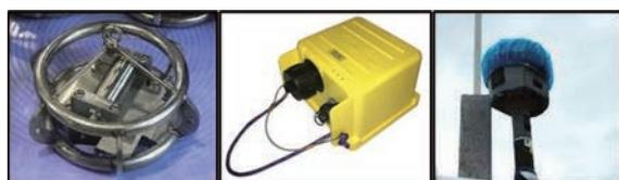
図-1 主な測定機器（海底地震計（左）、独立型データ収録器 ATOM（中）、RTK-GNSS アンテナ（右））
