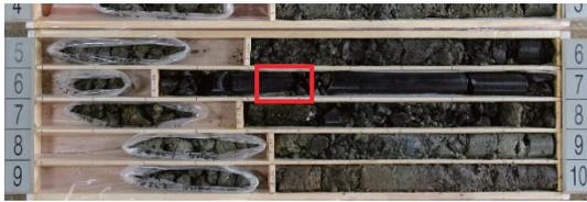
写真-6 薄片サンプル採取箇所
