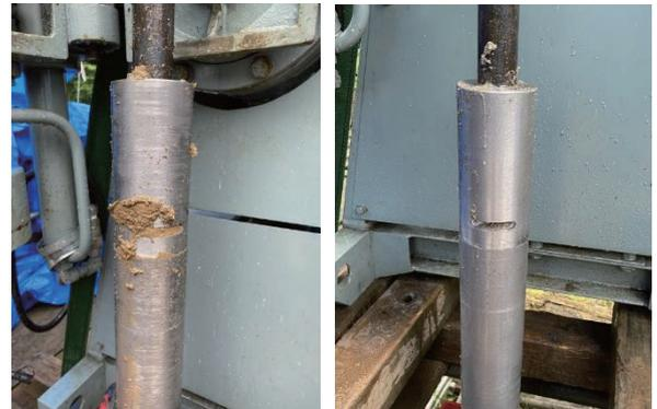
図-5 センサー電極部のスライム堆積状況（左側は粘土質、右側は砂質）
