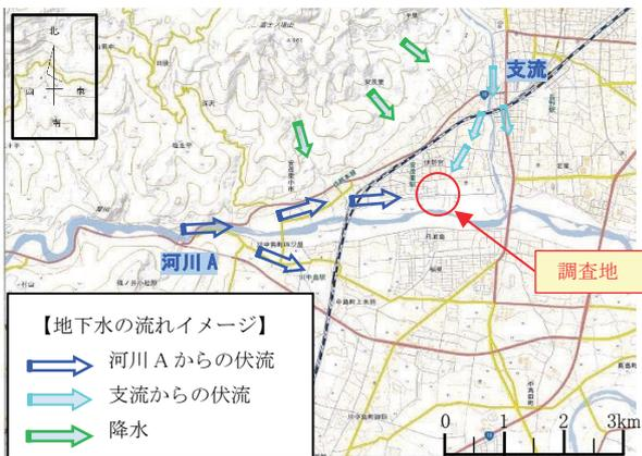
図-1 調査地の地下水供給機構の概念図<sup>1)</sup>
