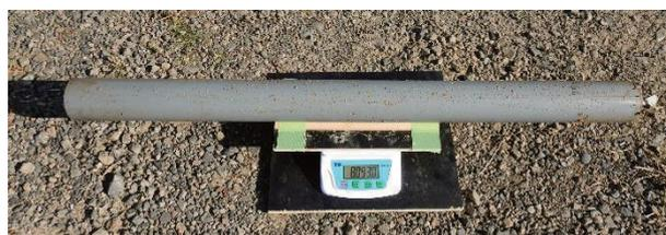
図-2 現場での試料の質量測定状況
