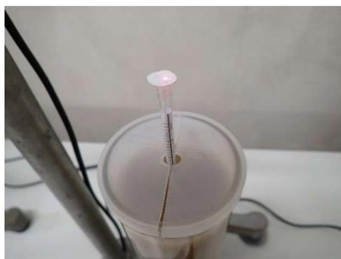
図-2 ターゲット板に当たるレーザー光線と浮遊防止のフタ
