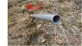
写真-9 No.2 孔地下水排出状況
