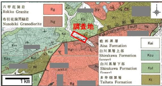
図-1 高取山断層周辺の地質図<sup>4)</sup>
